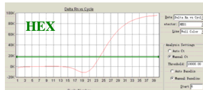
HEX 通道扩增曲线图 (Y轴: HEX 荧光信号值; X轴: 循环圈数)
